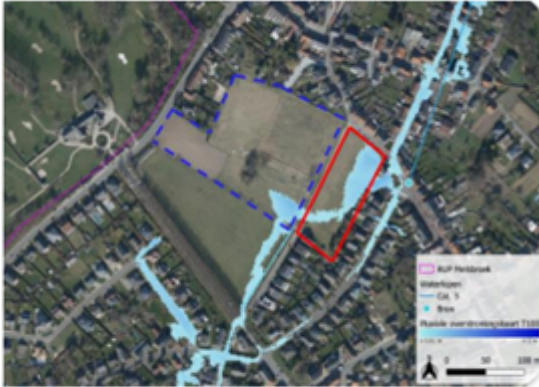
Figuur 67 Pluviale overstromingskaart T100 met binnen de rode contour de projectzone Lijsterlaan.
